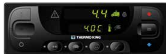
ÉCRAN DU CONTRÔLEUR STANDARD TSR-3 EN CABINE
