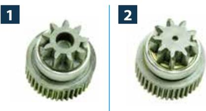
Ведущая шестерня стартёра испытывает значительные нагрузки, когда входит в зацепление с коронной шестернёй двигателя. Прочность и точность изготовления зубьев шестерни имеют решающее значение для срока службы стартёра и коронной шестерни. В стартёрах компании Thermo King для повышения прочности используется усиливающая кромка на ведущей шестерне, а также прецизионное производство, при котором обеспечивается плотное зацепление зубьев с коронной шестернёй для увеличения срока службы.
