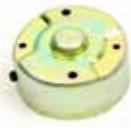
В стартерах компании Thermo King применяется концевой колпачок из литого алюминия вместо штампованной, оцинкованной стальной торцевой крышки, которую используют различные конкуренты. Алюминий лучше сопротивляется коррозии, а процесс обработки литья обеспечивает более прочную и долговечную конструкцию, что важно в условиях с высокой вибрацией.
