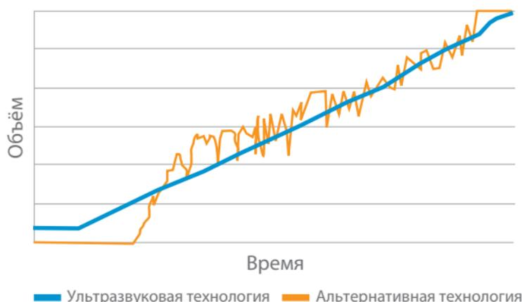
По сравнению с датчиками уровня топлива, в основе которых лежат альтернативные технологии, ультразвуковой топливный датчик обеспечивает более точные измерения уровня топлива, независимо от степени наполненности бака.
