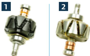
Los alternadores de Thermo King funcionan en entornos diésel, por lo que los procesos de pintura y barnizado son fundamentales para garantizar una larga vida útil de los alternadores. Todos los componentes esenciales se han pintado y barnizado para reducir el riesgo de corrosión y de cortocircuitos eléctricos.
