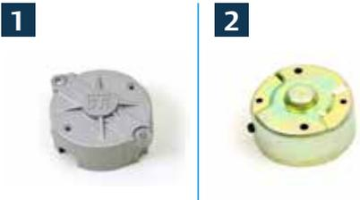
Los motores de arranque de Thermo King emplean una cofia de aluminio fundido en lugar de la cofia de acero estampado y chapado en zinc usada por varios de nuestros competidores. El aluminio resiste mejor la corrosión y el proceso de maquinado por fundición proporciona un diseño más resistente y duradero, lo cual es importante para aplicaciones con un alto nivel de vibración.
