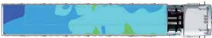
Mit Luftkanal: Die Temperatur ist gleichmäßiger verteilt.
